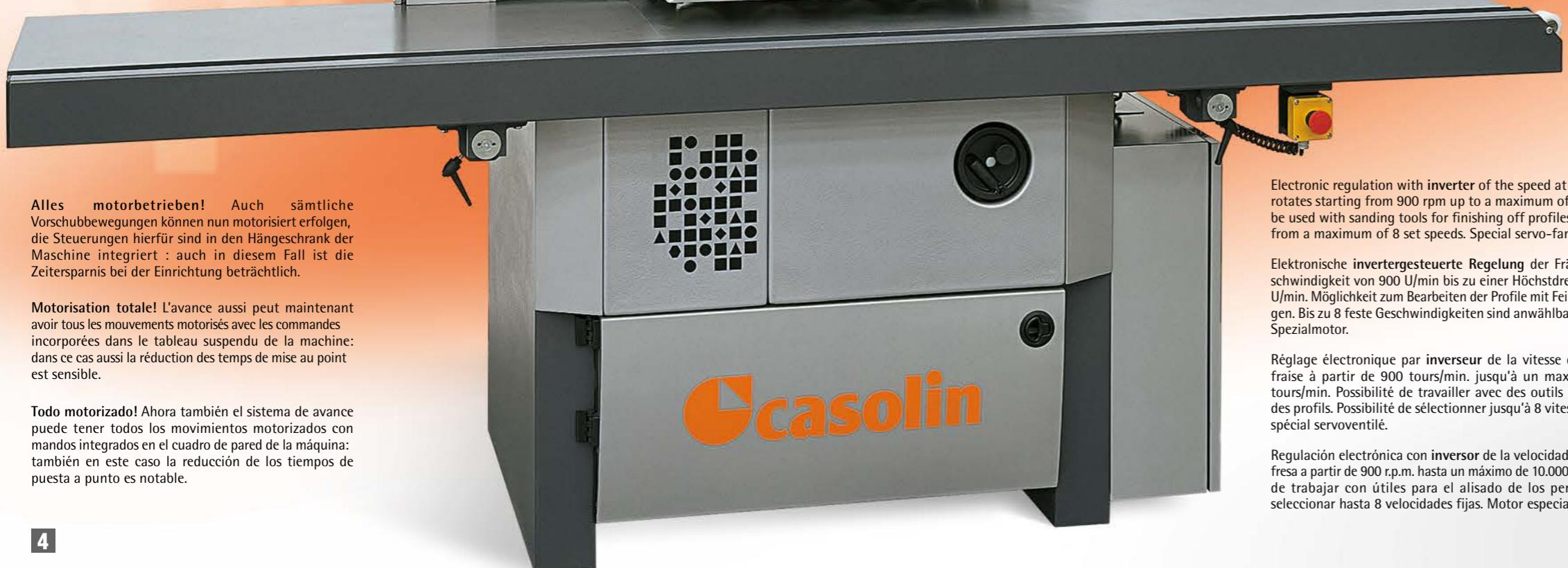
**Alles motorbetrieben!** Auch sämtliche Vorschubbewegungen können nun motorisiert erfolgen, die Steuerungen hierfür sind in den Hängeschrank der Maschine integriert: auch in diesem Fall ist die Zeiterparnis bei der Einrichtung beträchtlich.
