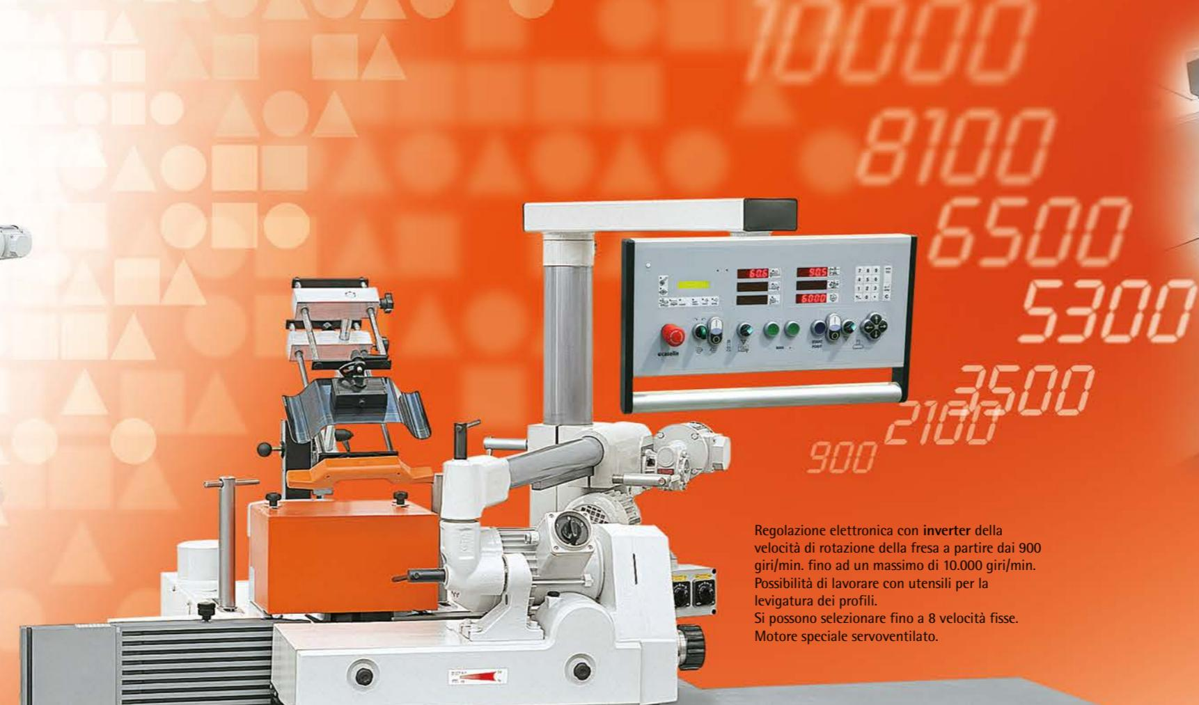
Regolazione elettronica con inverter della velocità di rotazione della fraise a partire dai 900 giri/min. fino ad un massimo di 10.000 giri/min. Possibilità di lavorare con utensili per la levigatura dei profili. Si possono selezionare fino a 8 velocità fisse. Motore speciale servoventilato.
