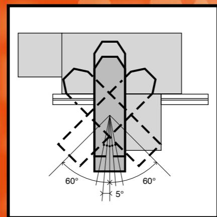
▲ Carro per tenonare completo di piano centrale prolungato per profilatura e piano superiore inclinabile - 60° + 60° per tenonatura. Inclinazione del piano superiore su tavola indexata con fissaggio attraverso spina inserita in fori di riferimento ogni 5° che garantiscono una elevata precisione. Possibilità di usare il carro per tenonare come prolunga piano nelle operazioni di profilatura.
