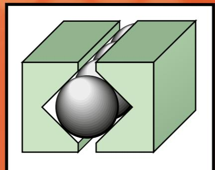
▲ La struttura ha una grande resistenza alla torsione e alla flessione. Lo scorrimento avviene su guide prismatiche in acciaio temperato con interposizione di sfere. (Punto di contatto delle sfere limitato per un sicuro scorrimento anche nelle condizioni più severe di lavoro).
