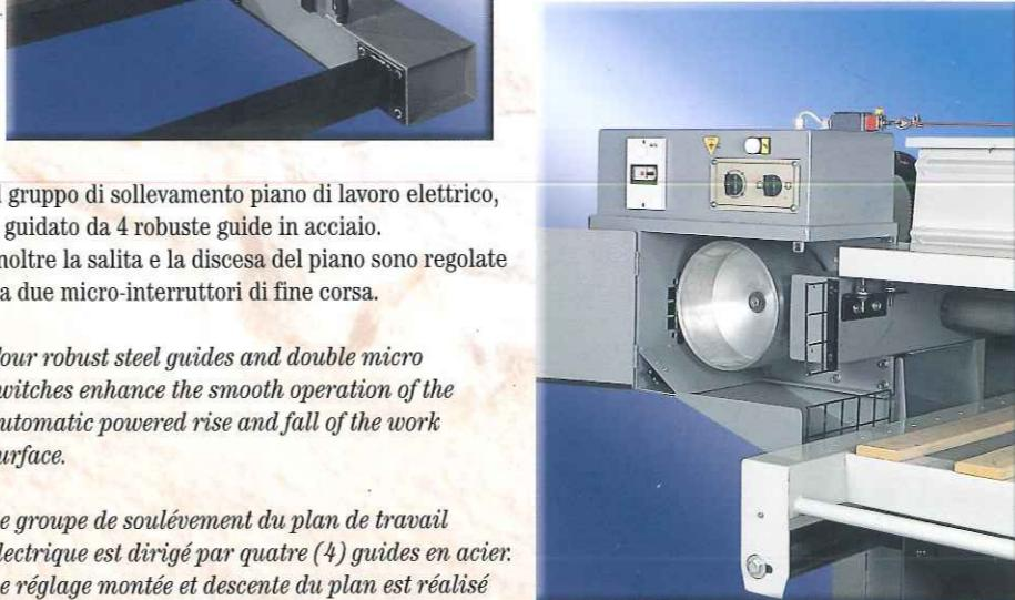
Il gruppo di sollevamento piano di lavoro elettrico, è guidato da 4 robuste guide in acciaio. Inoltre la salita e la discesa del piano sono regolate da due micro-interruttori di fine corsa.
