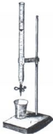
Figure 3. Burette de Mohr dans un dispositif historique de dosage par titrage.
