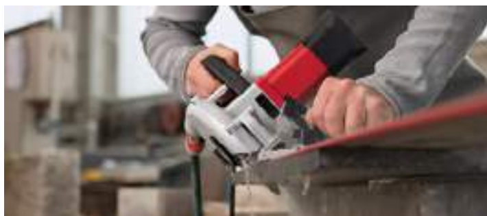
Réglage d'angle en continu pour coupes d'onglets de 0 à 45°
